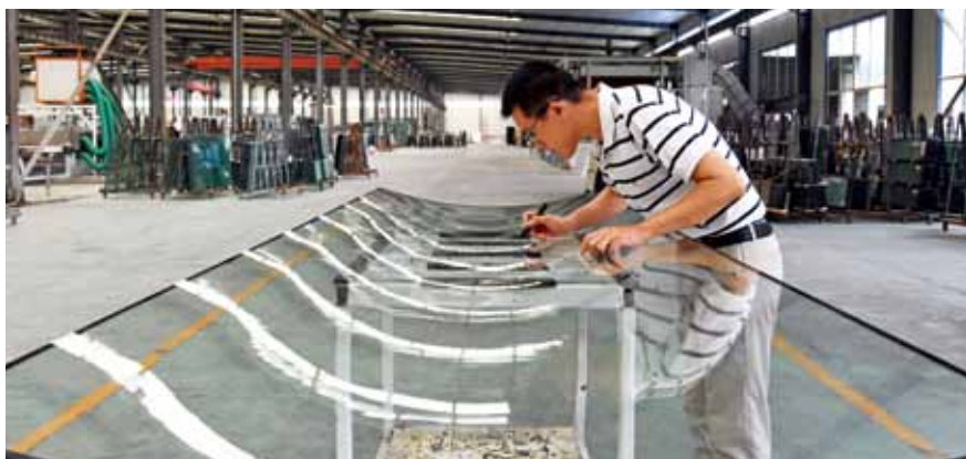
检查曲面复合防火玻璃表面通透性
